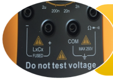
Fotoğraf 2.3: Lcrmetre prob bağlantısında dikkat edilecek hususlar.
