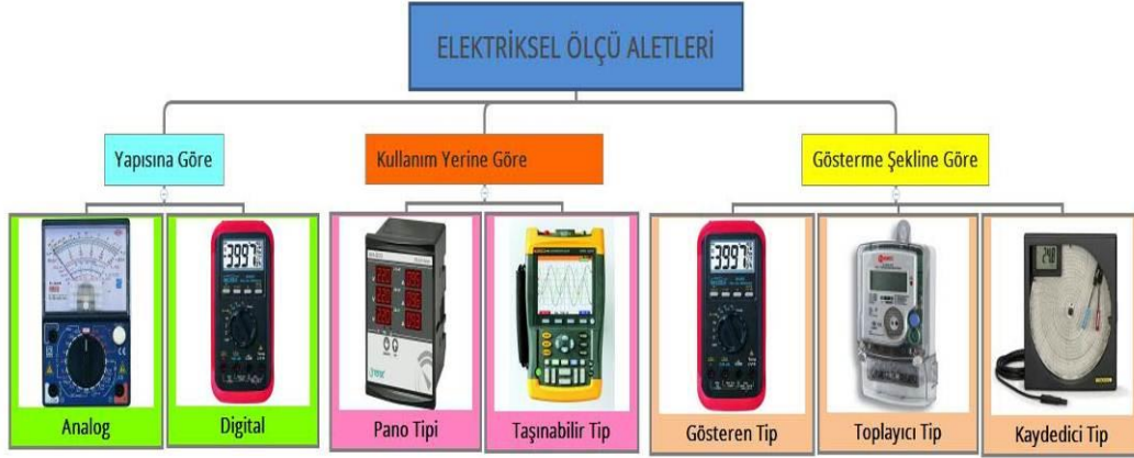
Fotoğraf 1.1: Ölçüm Aletlerinin Sınıflandırılması
