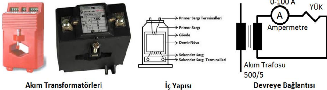
Fotoğraf 4.4: Akım transformatörlerinin iç yapısı ve devreye bağlanması
