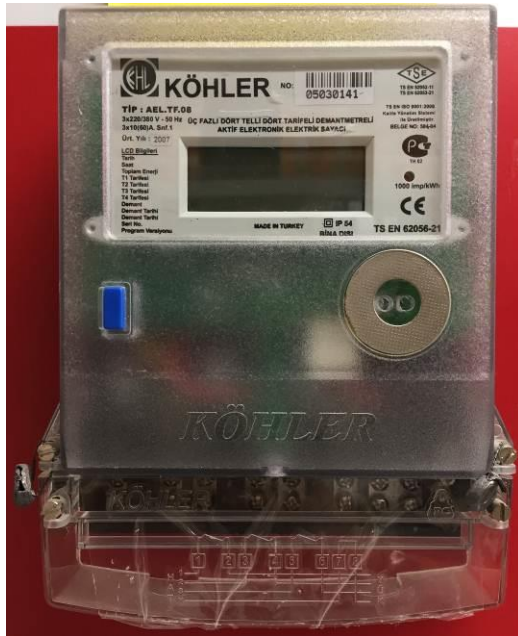
Fotoğraf 1.7: Toplayıcı ölçüm aletlerine en iyi örnek sayaçlardır
