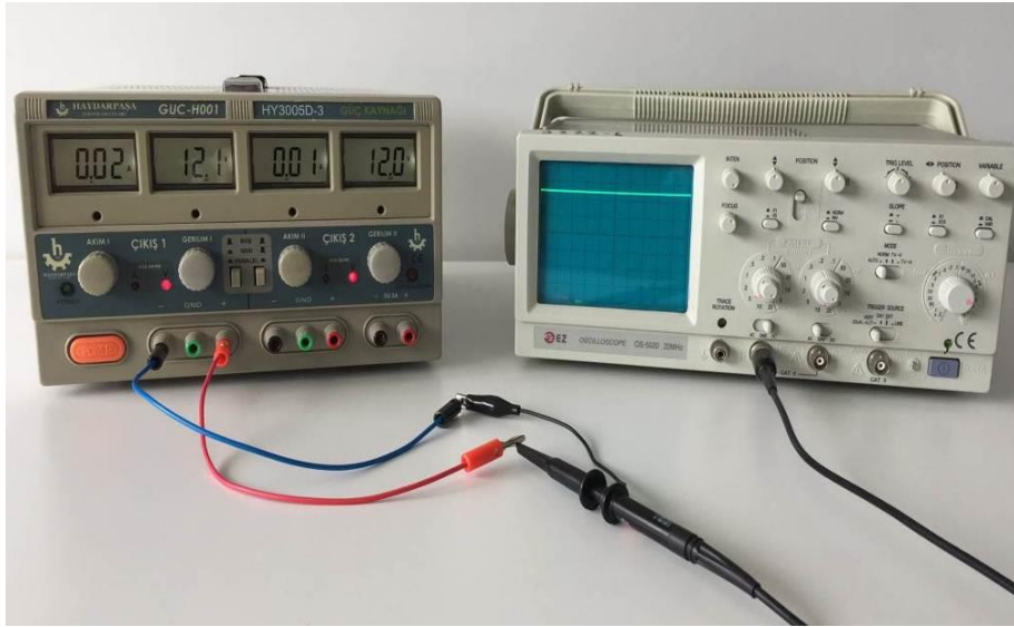
Fotoğraf 9.6: Osiloskop ile gerilim ölçme uygulaması
