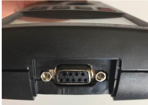
Fotoğraf 1. 11: Dijital ölçüm aleti haberleşme portu
