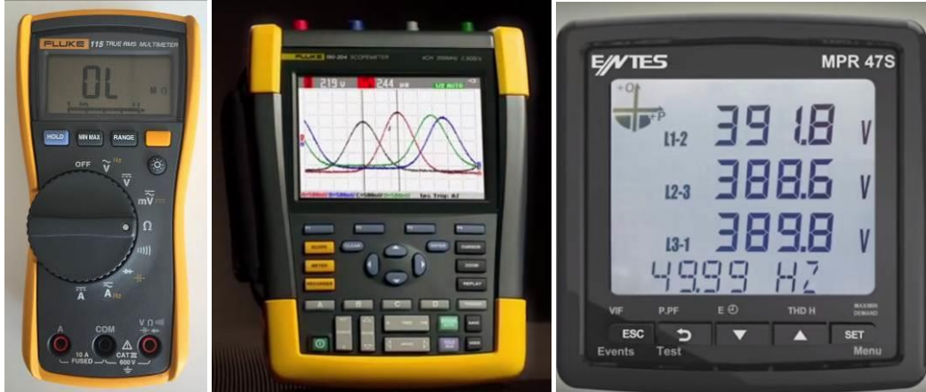
Fotoğraf 1.2: Tipik elektrik ölçü aletleri
