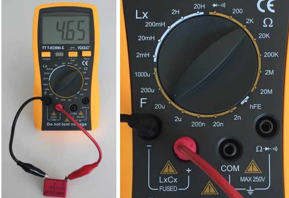
Fotoğraf 3.2: Lcrmetre ile kapasite ölçümü
