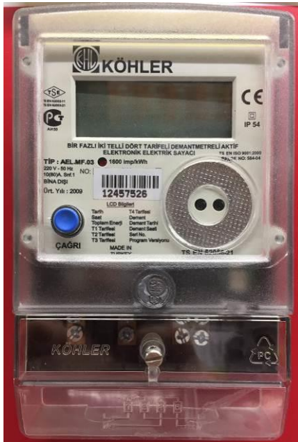
Fotoğraf 1.7: Toplayıcı ölçüm aletlerine en iyi örnek sayaçlardır
